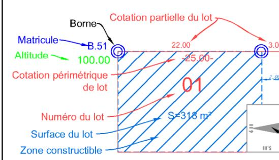
Nota : Il est impératif de s'appuyer sur le nivellement fourni par le Géomètre suite au bornage du lot. La position des branchements est définie d'après le plan PROJET établi par le Cabinet Quarta. Ce positionnement est approximatif (non contractuel), il peut être modifié en fonction des impératifs des travaux de viabilisation.
